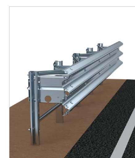
PARTICOLARE GUARD-RAIL DA REALIZZARE TIPO 'H2' Scala 1:25
